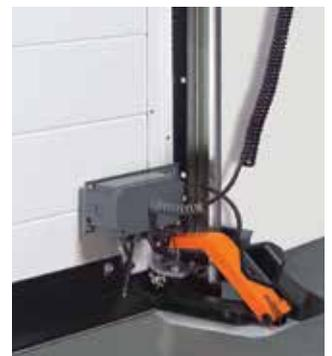
La sécurité anticollision latérale évite tout endommagement du pantographe de la porte en position fermée.
