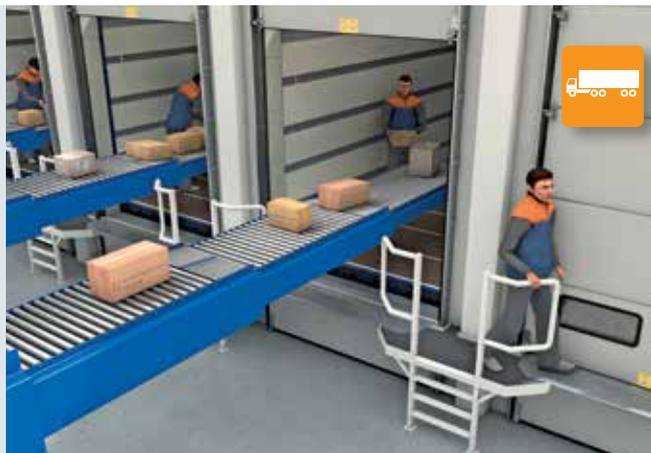
Lorsque la porte est ouverte, le panneau du bas reste au sol avec la plateforme piétonne pour le chargement des camions et container.
